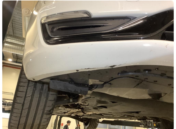
1.2 Noen skrubbskader underkant
