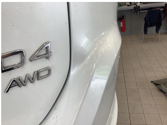
1.1 Liten plastskade på fanger
