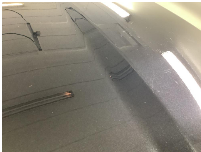
1.2 Noe steinsprut i front (Anses som normalt i henhold til alder/KM)
