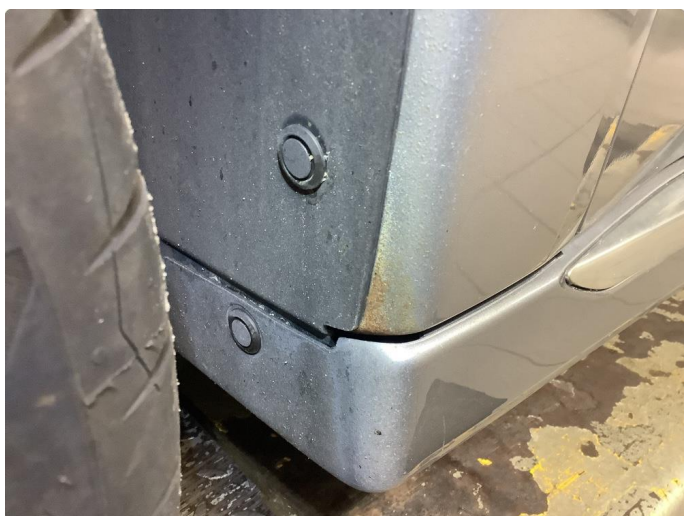
1.2 Noe korrosjon/rust - Legge i lakk
