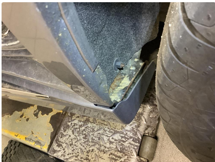
1.2 Noe korrosjon/rust - Legge i lakk
