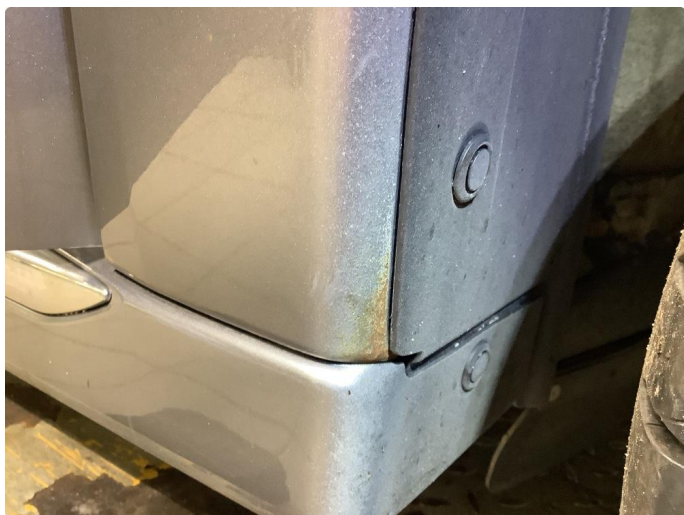
1.2 Noe korrosjon/rust - Legge i lakk
