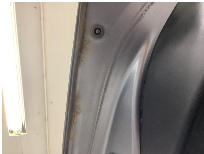
1.2 Noe korrosjon/rust - Legge i lakk
