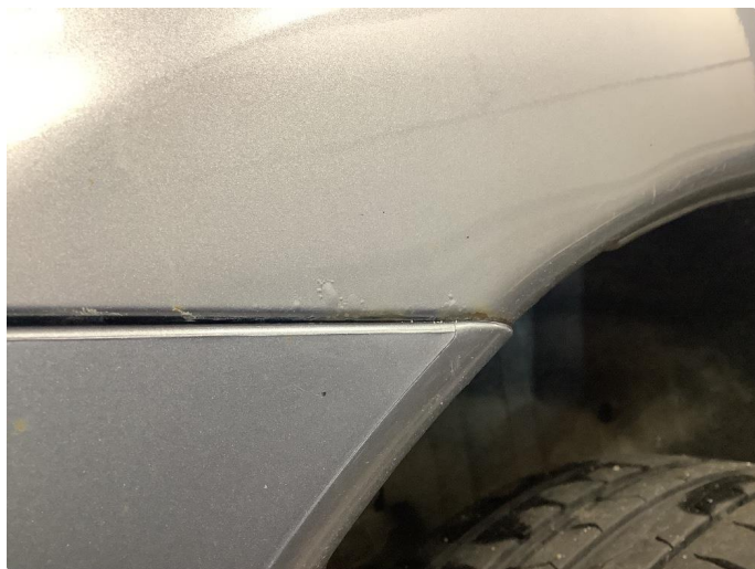
1.2 Noe korrosjon/rust - Legge i lakk
