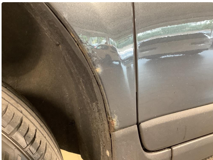
2.6 Generelt mye rust
