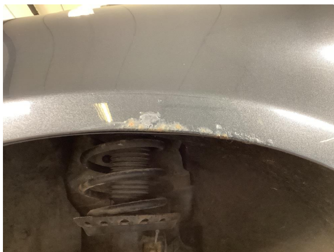
2.6 Generelt mye rust
