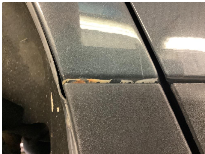
2.6 Generelt mye rust
