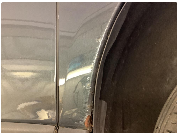
2.6 Generelt mye rust
