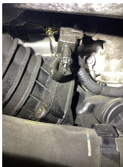
4.1 Oljelekkasje fra motor
