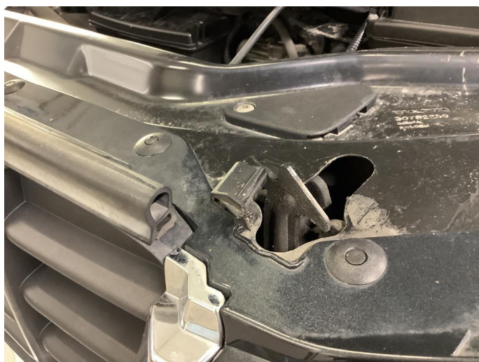
2.3 Feil på utvendig panseråpner
