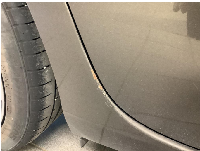
1.2 Generelt mye rust
