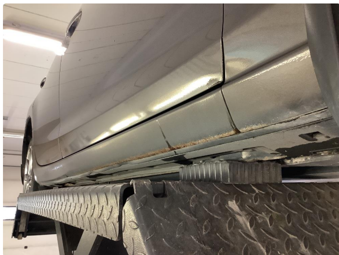
1.2 Generelt mye rust
