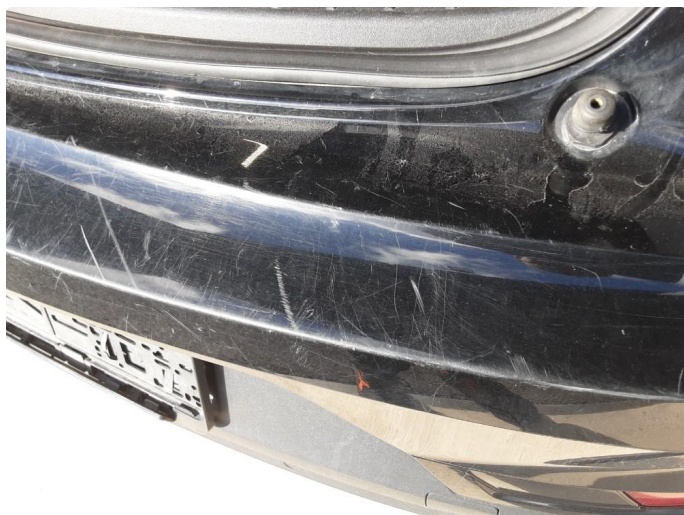
1.6 Ripe(r) ned til grunning
