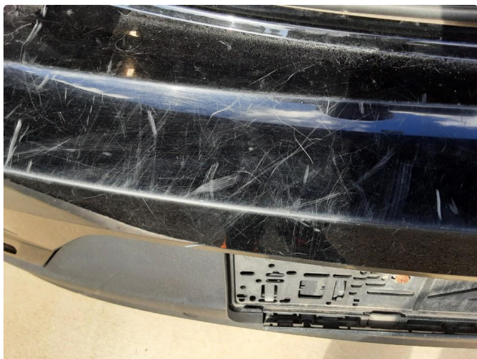
1.6 Ripe(r) ned til grunning
