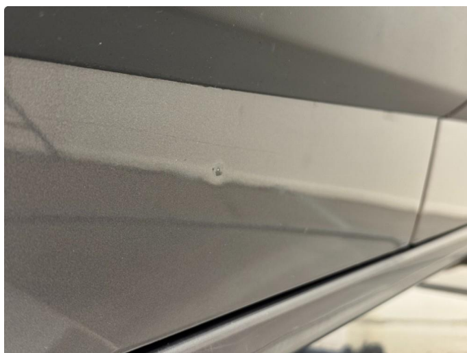
1.1 Generelt småmerker, riper og bulker, arbeidsbil
