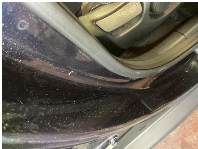
1.3 Bulk(er) med lakkskade i innsteg.
