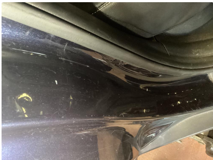
1.3 Bulk(er) med lakkskade i innsteg.
