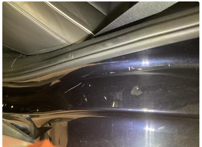
1.3 Bulk(er) med lakkskade i innsteg.
