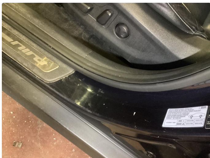
1.3 Bulk(er) med lakkskade i innsteg.
