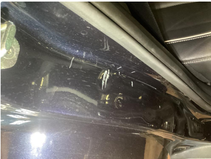
1.3 Bulk(er) med lakkskade i innsteg.
