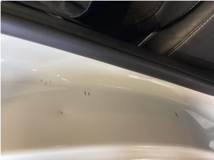
1.1 Noen riper og småbulker
