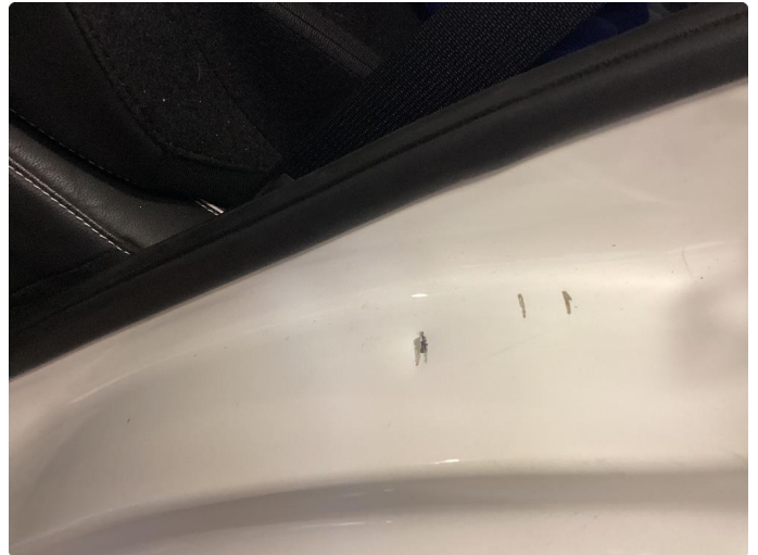
1.1 Noen riper og småbulker
