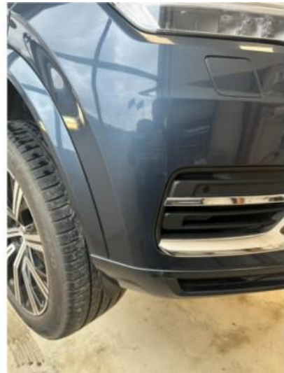
1.2 Noen riper i fanger høyre foran. Dempes med rubbing og polering
