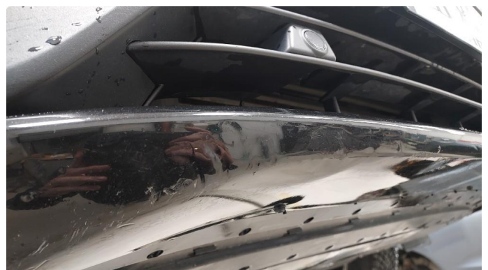
1.6 Litt oppripet på underside av fanger foran
