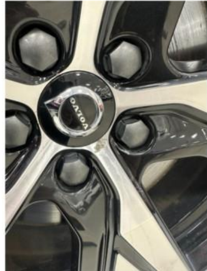
1.2 Påbegynnende oksidering på en vinterfelg
