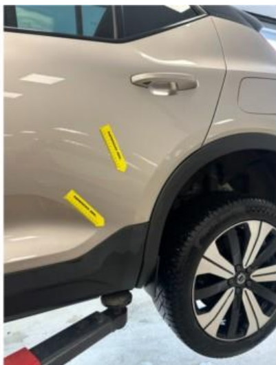
1.1 Ett par små steinsprut i dør venstre bak. Pusses og lakkeres forenklet
