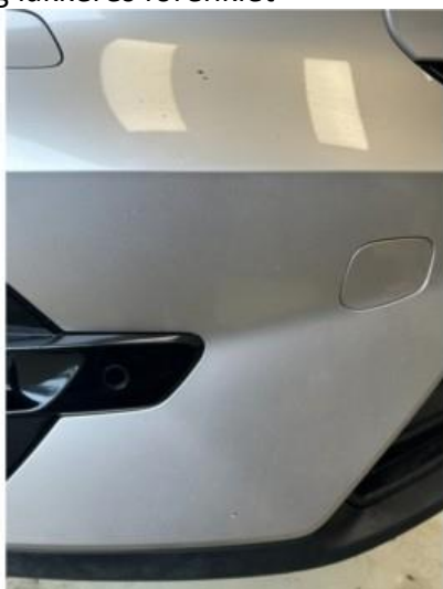
1.3 Noen små steinsprut i fanger høyre foran. Lakkeres forenklet
