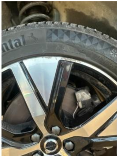
1.1 En vinterfelg litt kantkjørt
