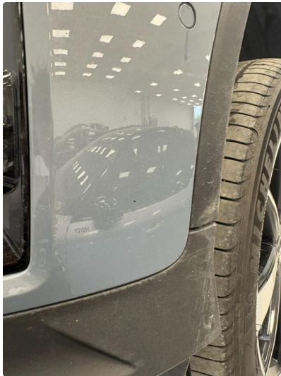
1.2 Noen steinsprut i fanger venstre foran
