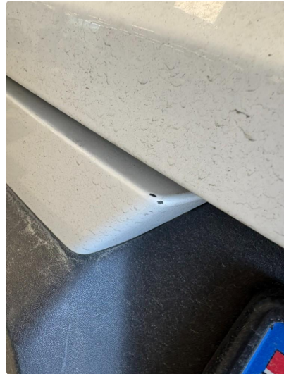
1.1 Ett par små hakk i fanger bak
