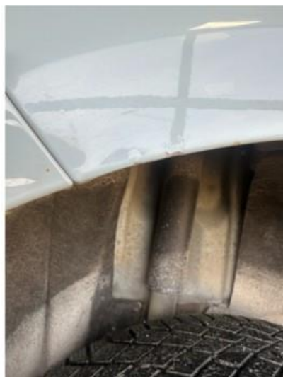
1.2 Noen steinsprut i skjerm/hjulbuer bak. Begge sider.
