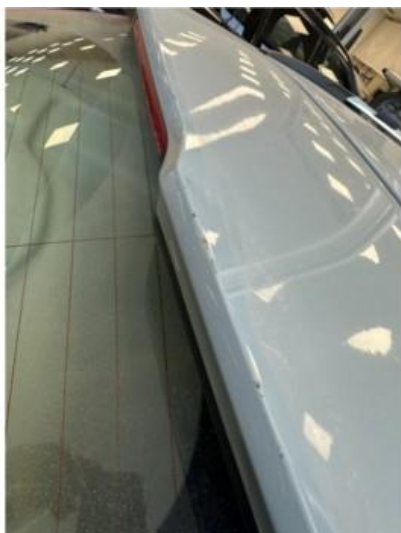
1.1 Små lakkskader opp på bakluke. Lakkeres forenklet
