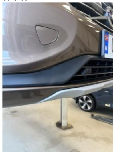
1.2 Noen små hakk i nedre del av fanger høyre foran
