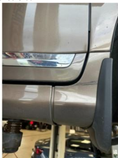
1.3 Noen riper i kanal + nedre del på dør høyre foran
