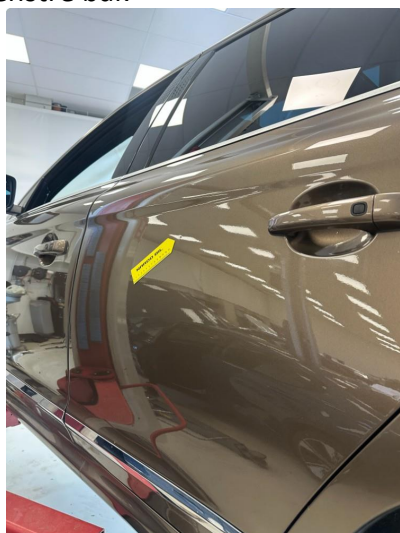
1.1 Noen små p.bulker i dør høyre foran, høyre bak og venstre bak
