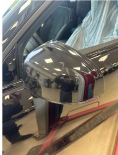
1.2 Noen riper i speilhus venstre foran. Dempes med rubbing og polering
