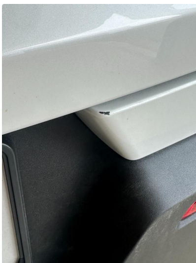
1.3 2 små hakk i fanger bak. Lakkeres forenklet
