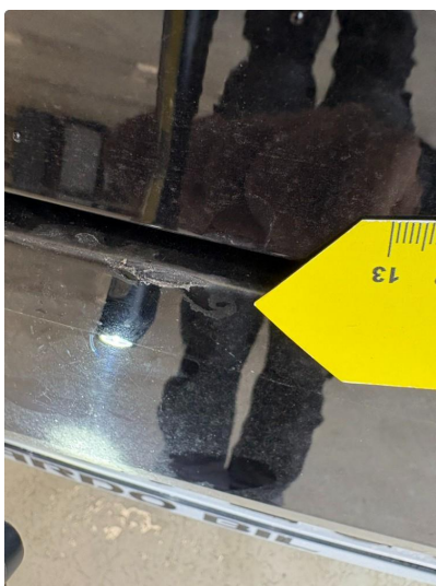
1.2 Liten lakkskade i fanger bak
