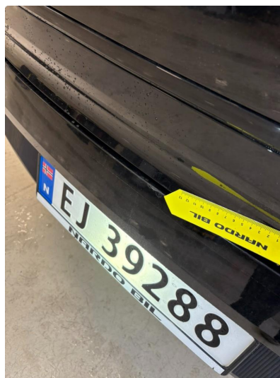
1.2 Liten lakkskade i fanger bak
