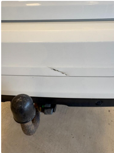
1.2 Liten skade i fanger bak. Lakkeres forenklet
