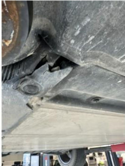
1.1 Liten sprekk i beskyttelsesplate under bil
