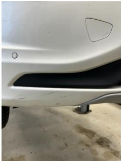
1.1 Noen riper i nedre del av fanger høyre foran
