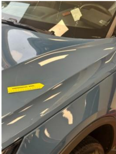
1.1 Noen riper i panser venstre side. Dempes med rubbing og polering
