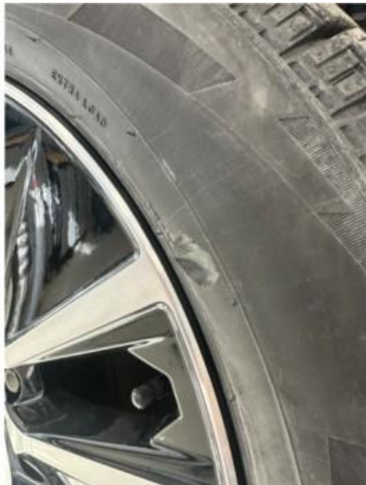
1.1 Liten dekkskade på ett vinterdekk. Godkjent
