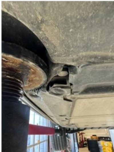
1.1 Lita sprekk i beskyttelsesdeksel under bil
