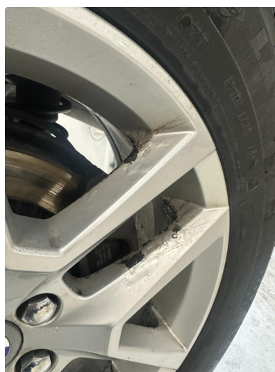
1.3 Påbegynnende oksidering på vinterhjul
