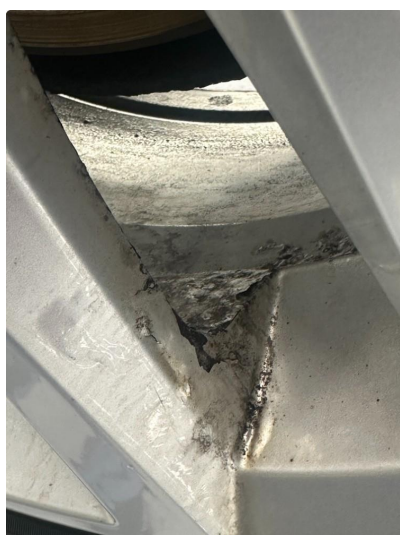
1.3 Påbegynnende oksidering på vinterhjul
