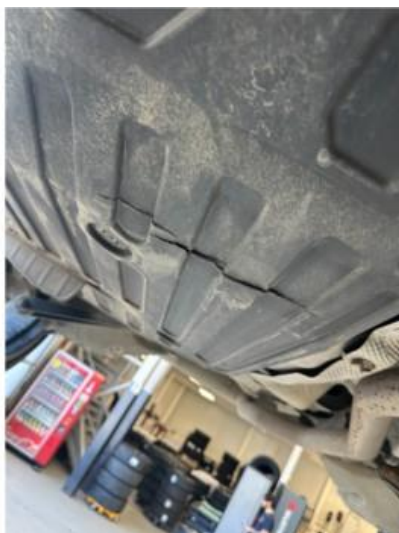
1.1 Lita sprekk i beskyttelsesplate under bil. Normal slitasje
