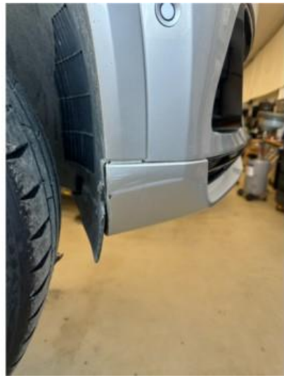
1.5 Riper i fanger høyre foran. Vil bli lakkert forenklet
