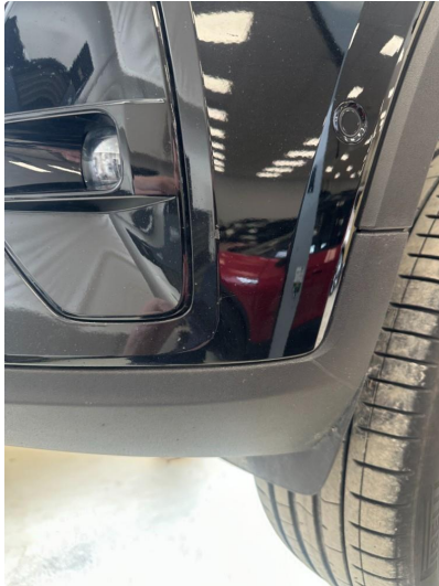
1.1 Liten steinsprut i fanger venstre foran. Lakkeres forenklet.
