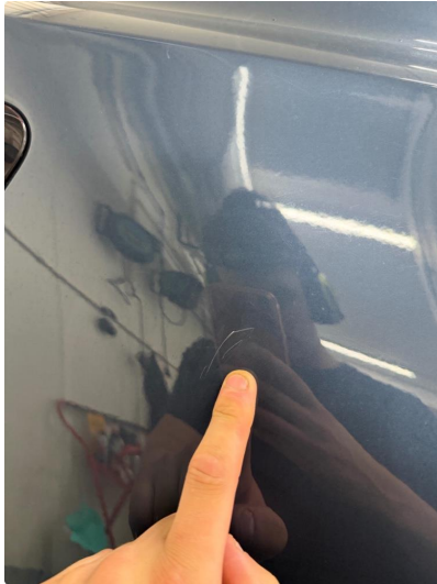
1.1 Ripe på skjerm høyre bak. Dempes med rubbing og polering
