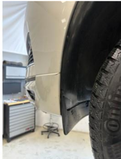
1.2 Noe hakk/riper i nedre del av fanger foran
