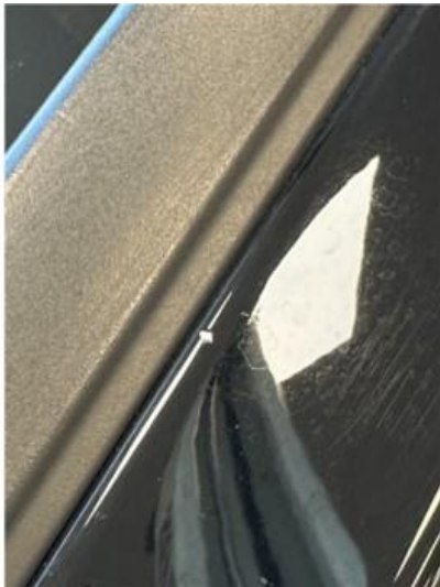
1.3 Steinsprut. A-pilar V-side + forkant av tak: flekkes
