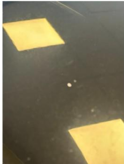
1.3 Steinsprut. A-pilar V-side + forkant av tak: flekkes
