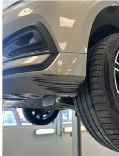
1.2 Noe oppripet på underside av fanger foran.
