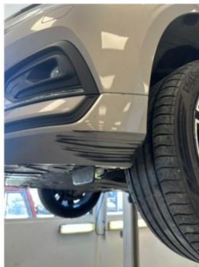
1.2 Noe oppripet på underside av fanger foran.
