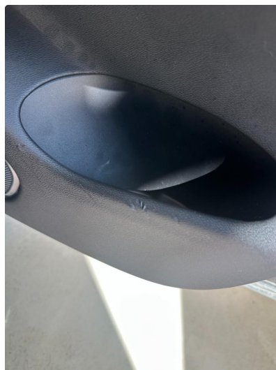
2.1 Noen merker i dørtrekk høyre bak
