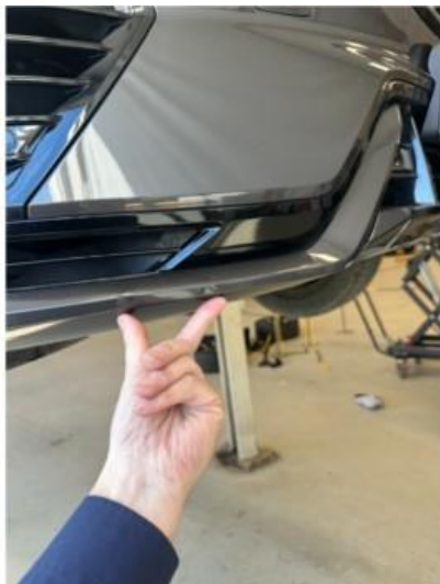
1.3 Noen små bulker på nedre del av fanger foran. Ubetydelig.
