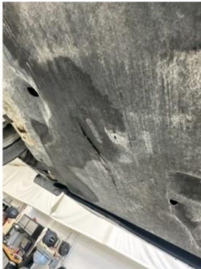
1.1 Noen sprekker i beskyttelsesplate under bilen
