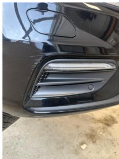
1.4 Noen riper i fanger høyre foran. Dempes med rubbing og polering
