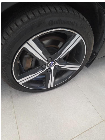
1.3 En sommerfelg noe kantkjørt
