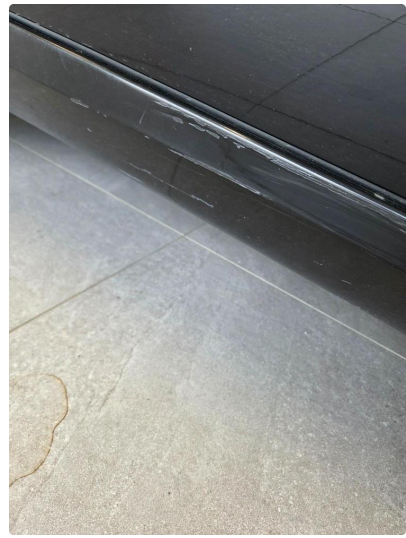
1.6 Bulk med noen riper i lakker i kanal høyre side
