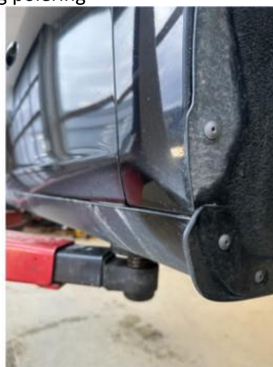
1.5 Noe matt lakk i kanaler begge sider + noen lakksår
