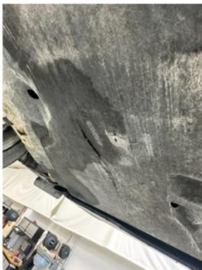
1.1 Noen sprekker i beskyttelsesplate under bilen
