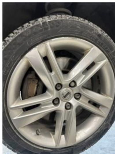
1.2 En vinterfelg litt kantkjørt
