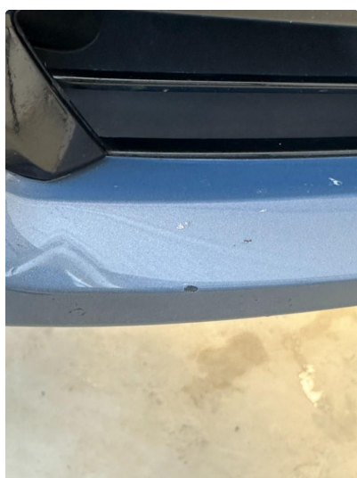
1.3 Noen riper/hakk i nedre del av fanger foran. Lakkeres forenklet. Høyre side
