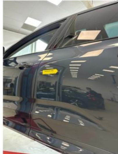
1.2 Lite lakksår i dør venstre bak. Slipes og poleres
