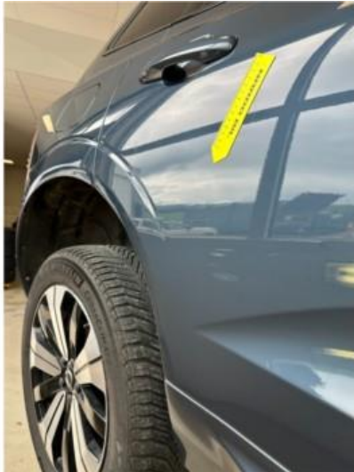
1.1 Noen riper i dør høyre bak. Dempes med rubbing og polering
