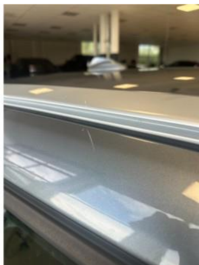
1.2 Ripe på tak høyre side. Dempes med rubbing og polering
