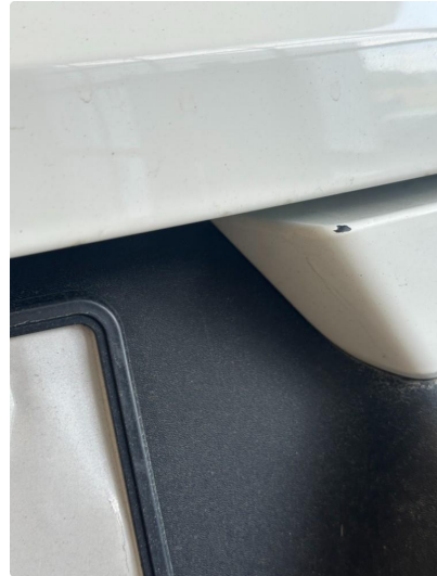
1.1 Små hakk i fanger bak. Vil bli lakkert forenklet
