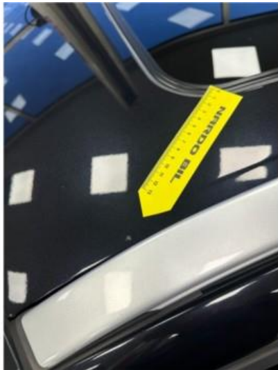
1.3 Liten steinsprut oppe på tak venstre foran
