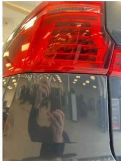
2.1 Litt krakelering i plast lykt venstre bak
