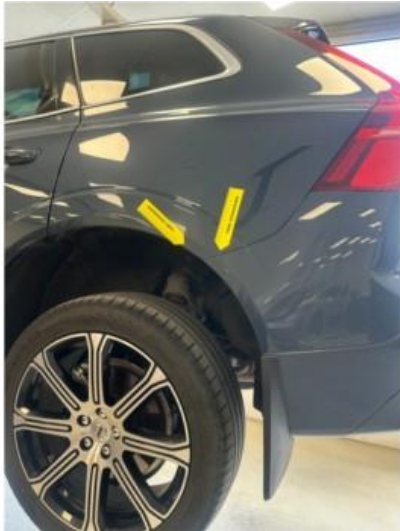
1.1 Noen merker/hakk i hjulbue venstre bak
