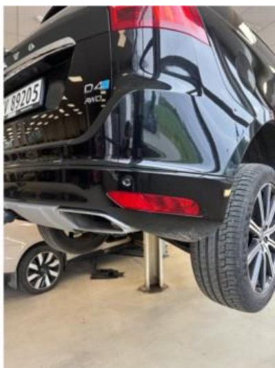
1.3 Tidligere flekkklakkert i fanger høyre bak. Vil bli pusset over for bedre resultat
