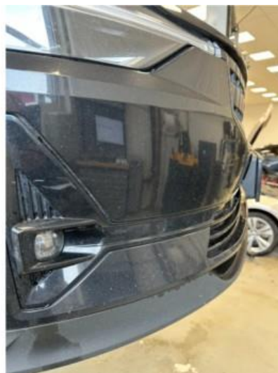
1.2 Noe steinsprut i fanger foran
