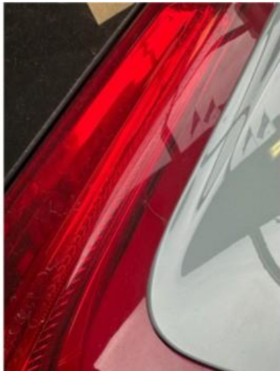
1.1 Lita sprekk i lys høyre bak
