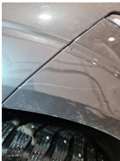
1.2 Noen små riper i fanger høyre foran. Dempes med rubbing og polering
